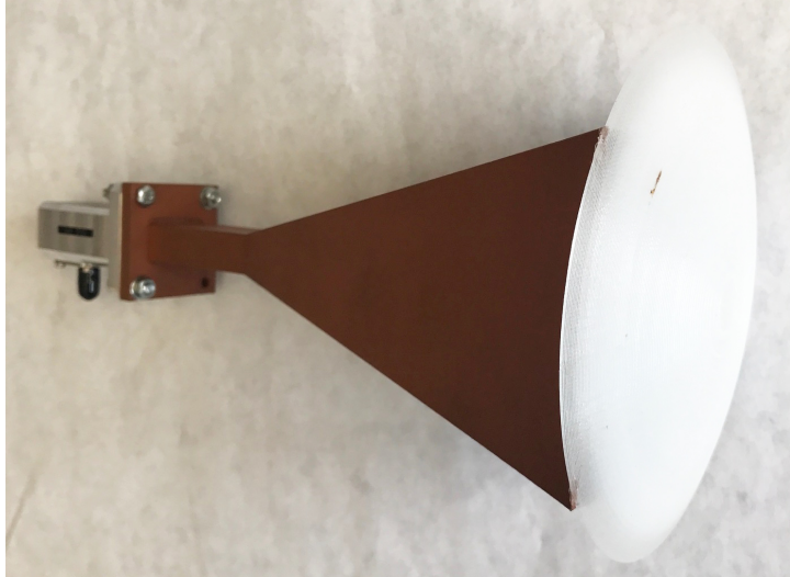
Obrázek 4-5: Realizovaná struktura s následným nánosem EMI 25 osazená čočkou
