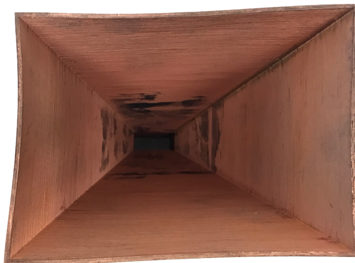
Obrázek 4-7: Deformace a nedokonalosti v dutině výsledné pokovené struktury
